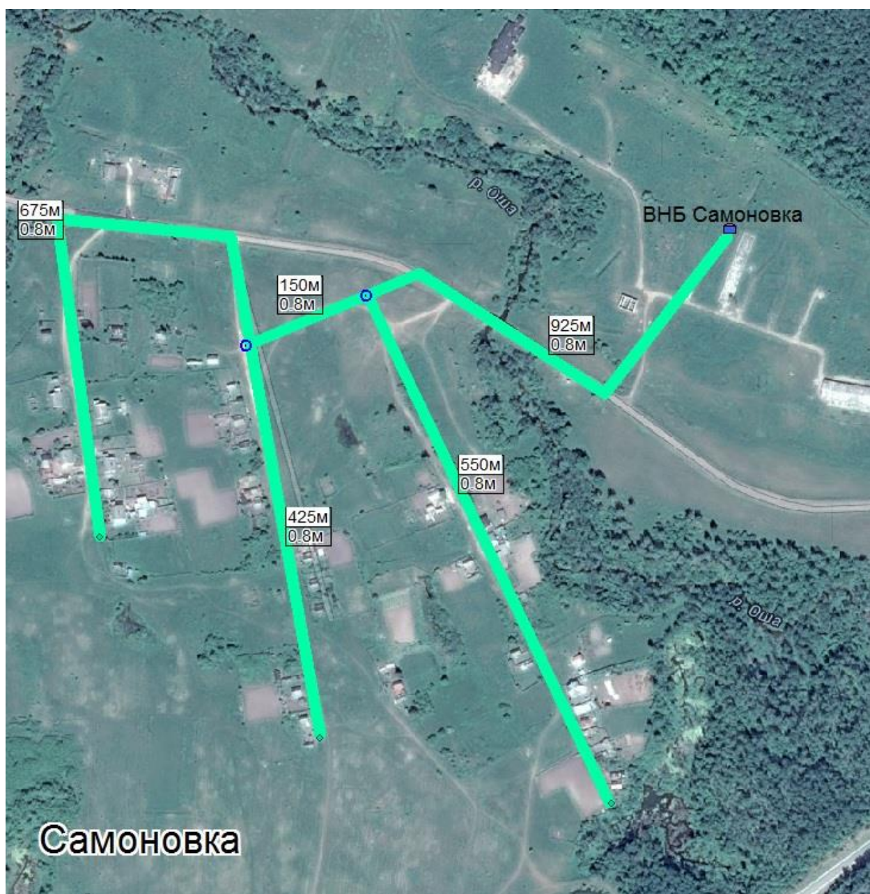
Рисунок 1-7. Зона централизованного водоснабжения н.п. Самоновка
