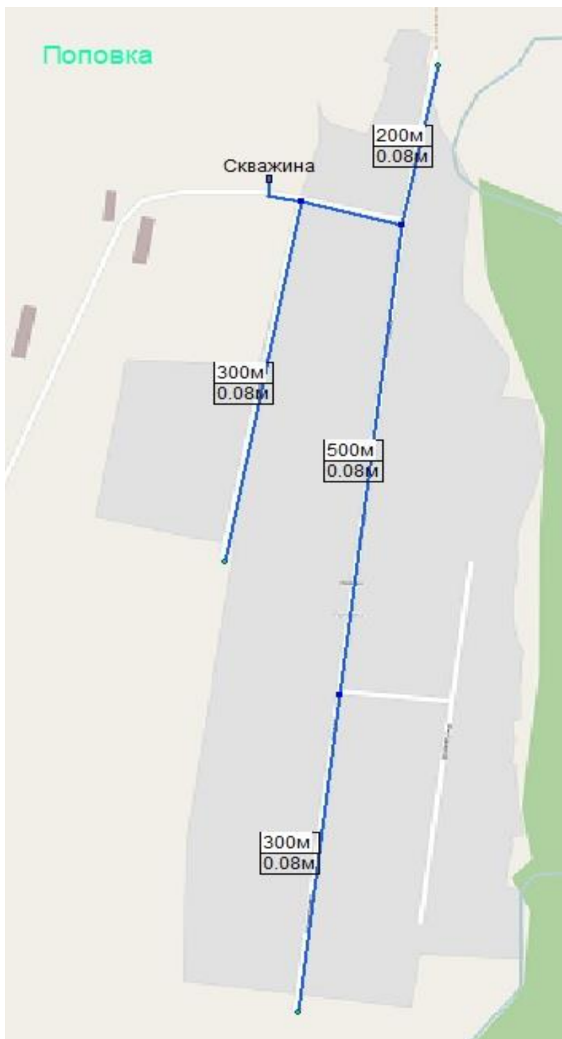
Рисунок 1-6. Зона централизованного водоснабжения н.п. Поповка
